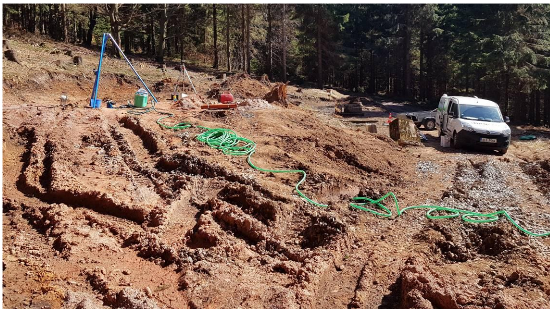
Obr. 3 Čerpací zkouška na vrtu HVC-1
